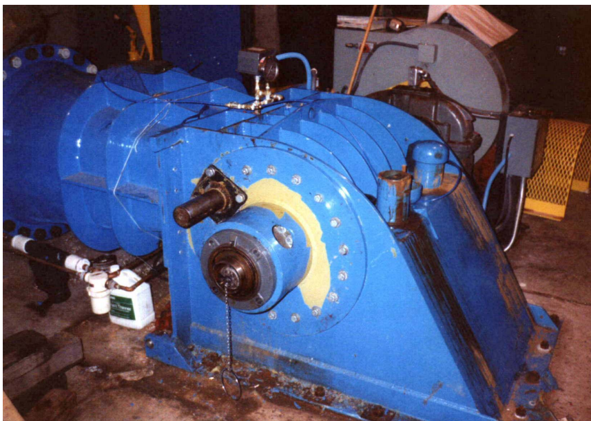
No. 1: Nouvelle panne de turbine - arbre de roue cassé Après dix ans de fonctionnement intermittent, la turbine part à la ferraille
