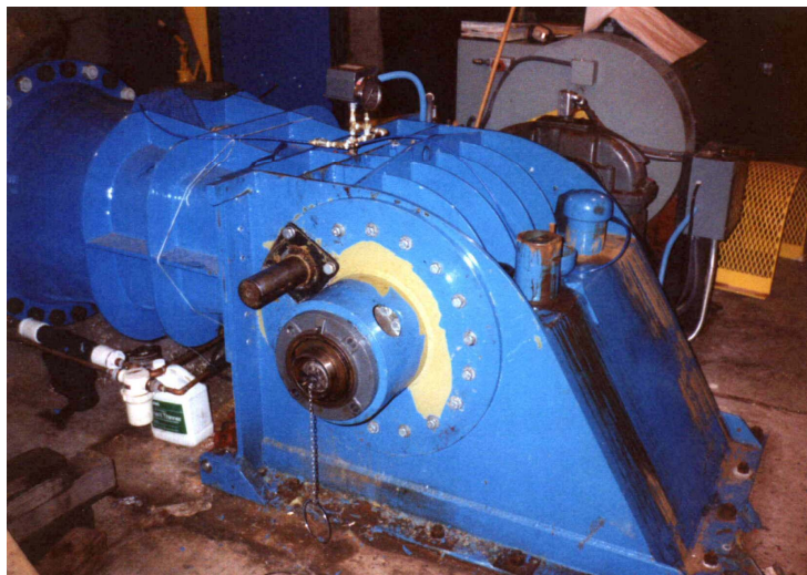
Figure 1: Turbina otra vez fuera de servicio - esta vez un eje de rodete roto - después de diez años de funcionamiento intermitente – sólo es chatarra
