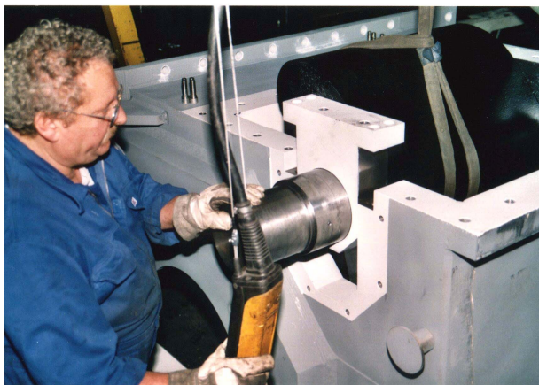
Fig. 4: Montaje de los álabes directrices con el conjunto de buje en la carcasa de la turbina.
