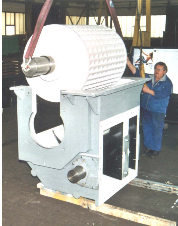
Fig. 5: Montaje del rodete en dirección radial al eje de la turbina.
