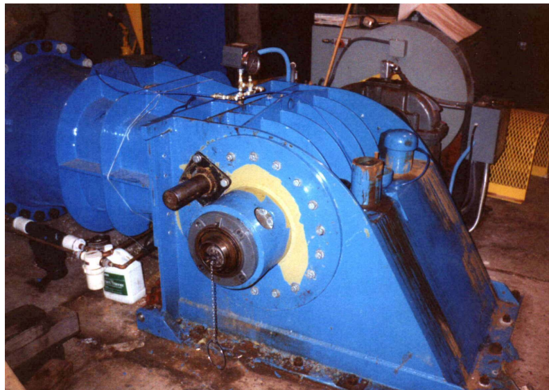
Abb. 1: Turbine wieder außer Betrieb - Diesmal Laufrad gebrochen Welle - Nach zehn Jahren zeitweisen Betriebes - Ab zum Schrottplatz
